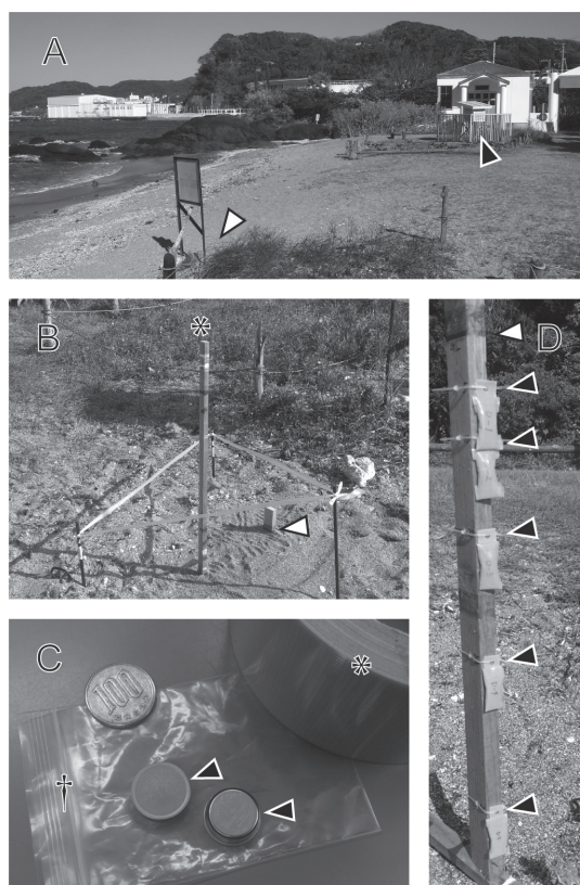
第2図 地中温度測定のために埋設した機材一式と地表温度測定補助材。A：設置点の位置と環境。黒矢じりは百葉箱，白矢じりは地表・地中温度観測点の位置を示す。B：地表・地中温度観測点の様子。＊は放射温度計を上面に載せて地表温度を測定するための地上高70 cmの木杭，白矢じりは埋設した地中温度測定機材（C, Dを参照）。C：各深度に取り付けた温度自動記録装置（黒矢じり。実際には各深度1つずつ）と防水資材（＋：チャック袋，＊：クロステープ）。D：防水加工を施して深度毎に木杭に固定した温度自動記録装置（黒矢じり）。白矢じりは埋設時の地表レベル。
