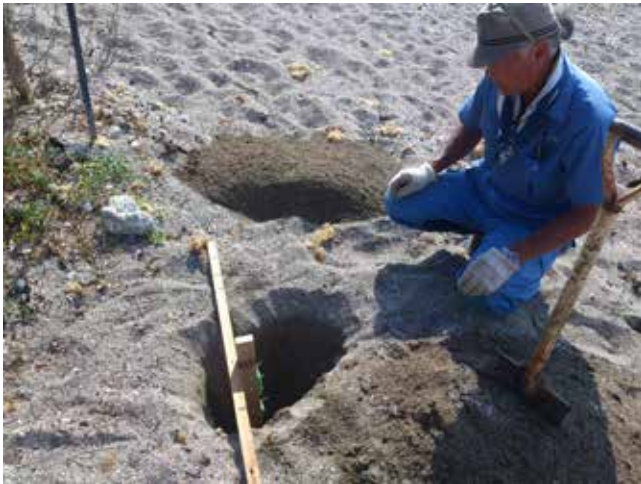
温度センサーを棒に固定して砂浜に埋めました
